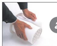
消音膜ろ材を交換します。
