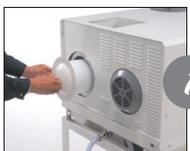
ローレットボルトを外して、消音膜ユニットを取り出します。
